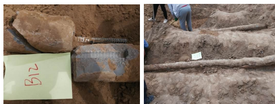
(b) 锚固长度为 5.0 m, BFRP 锚杆
