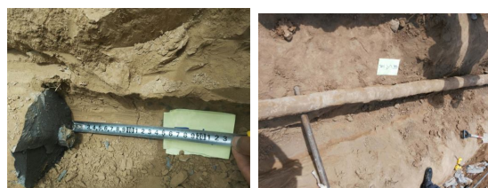
(d) 锚固长度为 5.0 m, 钢筋锚杆
